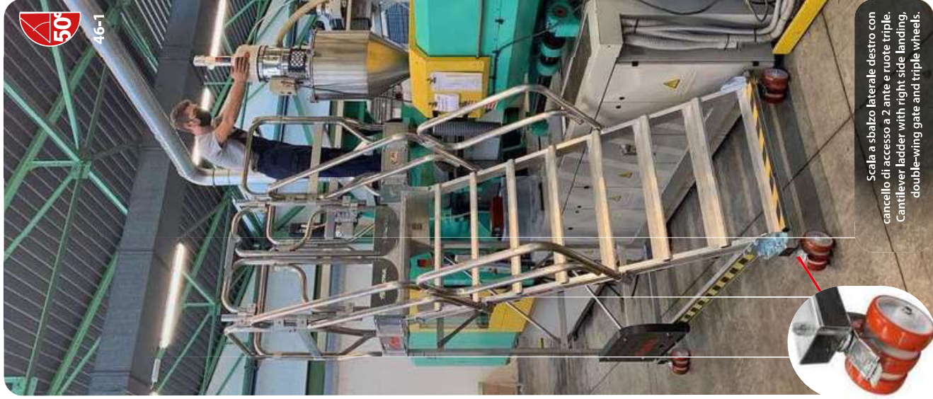
Scala con sbalzo laterale. Ladder with side landing.
