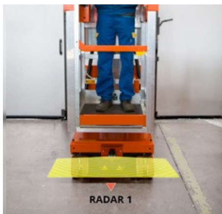
RADAR1 Système anticollision frontal. radar
